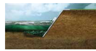
Proteção de taludes
