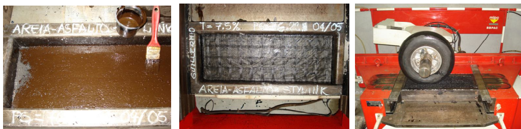
Figura 3 – Moldagem dos corpos de prova.
