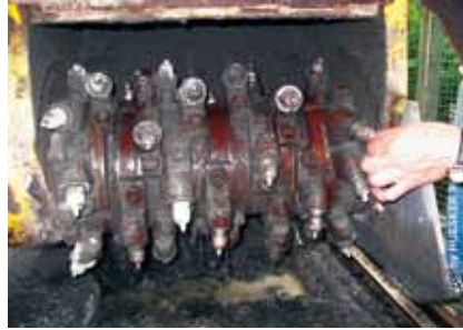
Bild 5: Nahezu keine Fasern haben sich um die Fräsrolle gelegt
