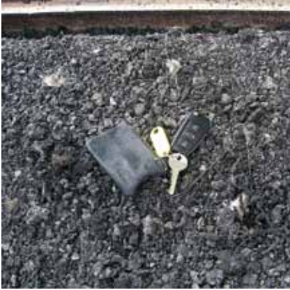
Bild 4: Nur kurze Restfasern des Gitters sind im Fräsgut zu erkennen
