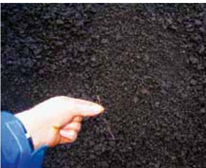
Bild 7: Nur kurze Restfasern des Gitters sind im Fräsgut zu erkennen
