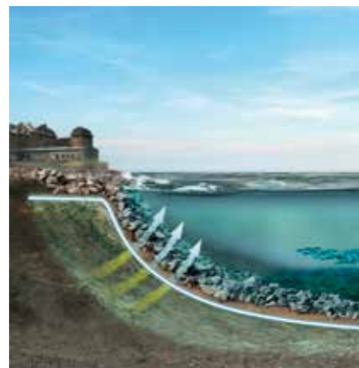
Sicherung kontaminierter Sedimente
