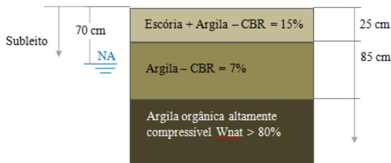
Figura 2. Seção da via não pavimentada existente
