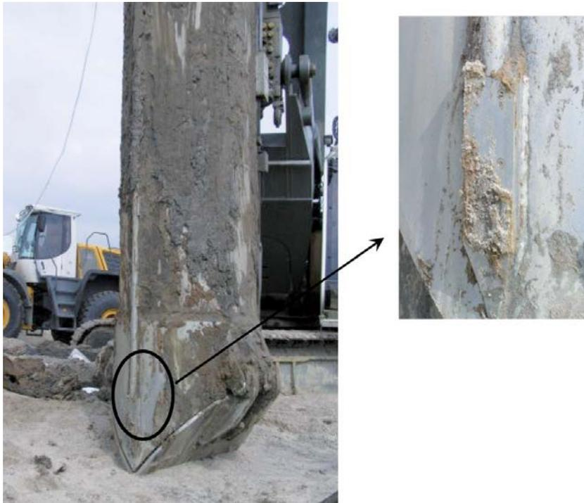
Bild 12. Verdrängungsrohr mit Messtechnik für Erfassung akustischer Signale (Quelle: Josef Möbius Bau-GmbH)
