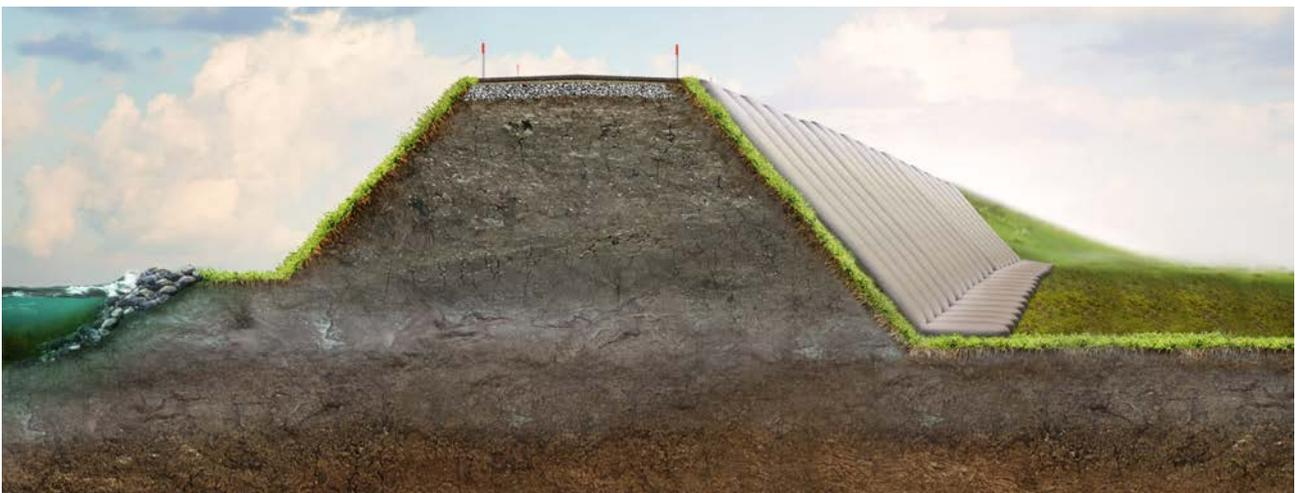
Bild 2: Schlauchmatte als einseitige Anwendung an Luftseite des Deiches
