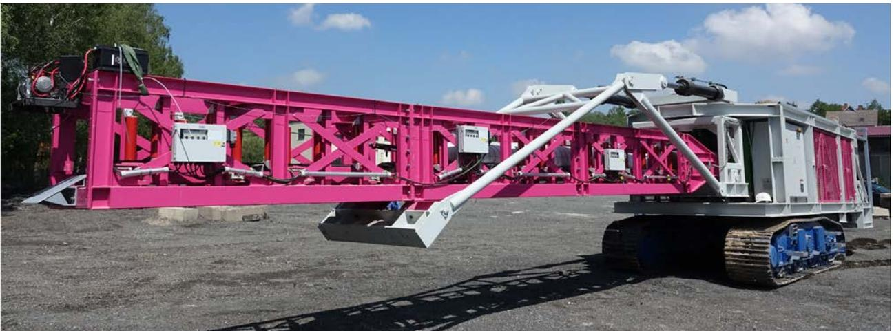
Bild 8: Schlauchfertiger (Dybatec)
